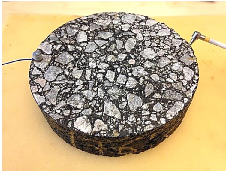
Figur 2. Mätning av en laborietillverkad disk-formad provkropp med sågade ytor (1)
